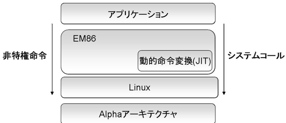
図 2.2.4 EM86 のエミュレーション方式
